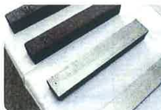
厚板を溶解し、成分調整した鋳鉄
